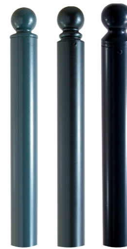
Stilpoller mit Kugelkopf aus Stahlrohr ca. 900 mm Überflur, feuerverzinkt und beschichtet.
